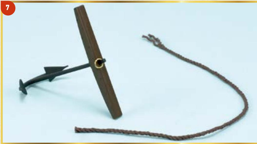
**7** Возьмите второй якорь модели, над которым вы работали по инструкциям выпуска 17. Кроме того, отрежьте 25 см коричневой нити диаметром 2 мм, полученной вами с выпуском 4. Нанесите на концы нити немного клея, чтобы они стали жестче, а затем опалите наружный ворс нити.
